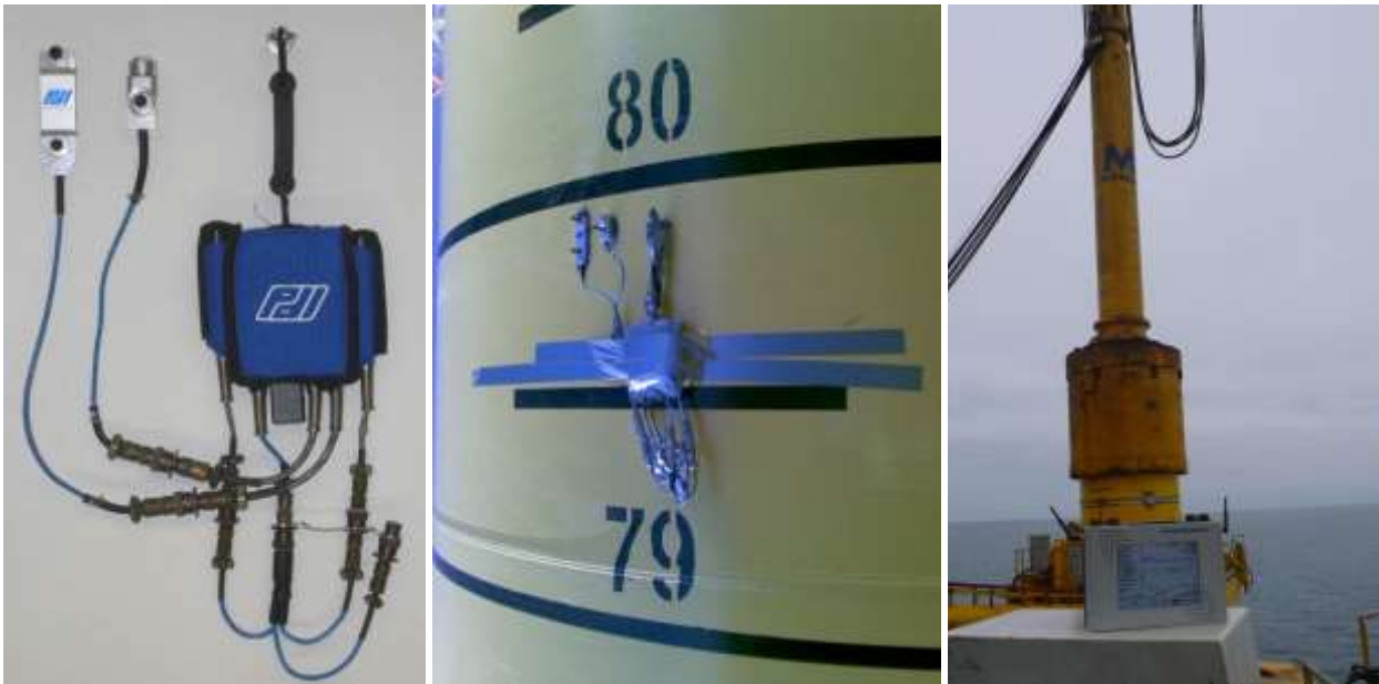
Bild 1: Sensoren und Sendeeinheit (links und Mitte), Messgerät mit Empfängereinheit und Sensoren am Pfahl während des Monitoring der „Überwasser“-Rammung im OWP Bard Offshore 1 (rechts)
