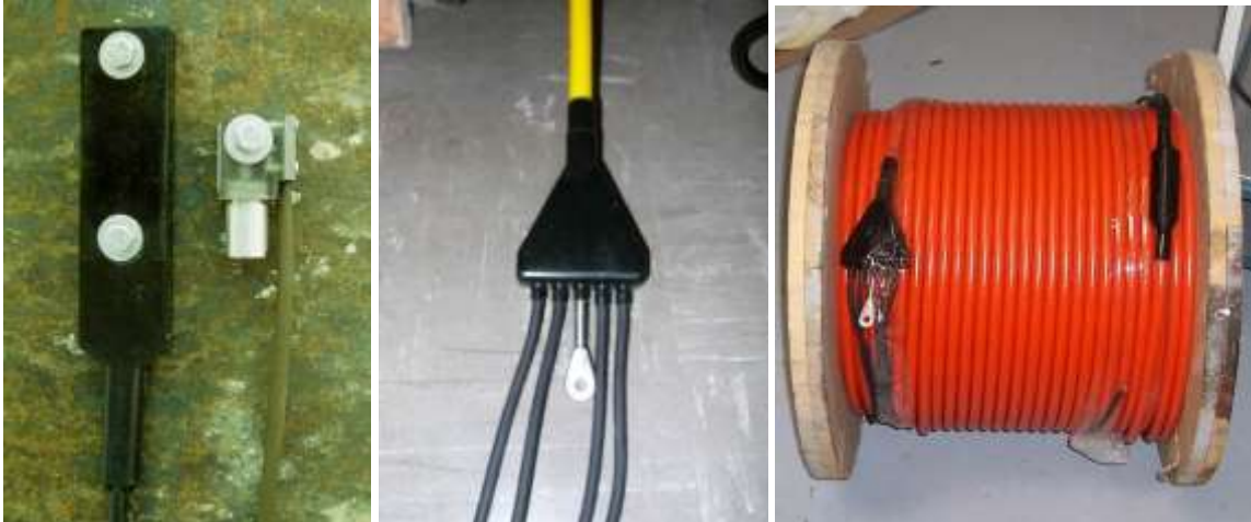
Bild 2: Dehnungs- und Beschleunigungssensoren (links) für Messung bis in große Wassertiefen, Verbindung zum Hauptmesskabel mit Zugsicherung (Mitte), nach erforderlicher Länge konfigurierbares Messkabel von den Sensoren am Pfahl zur Messstation (rechts)
